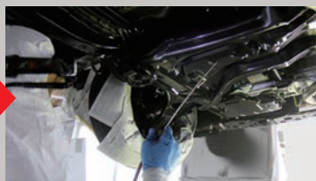
油性浸透剤「半透明」を既存穴から空洞部分に塗布(約0.25～0.5ℓ)
