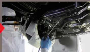
無公害な油性浸透剤「ブラウン」を既存穴から空洞部分に塗布(約0.5~0.75ℓ)
