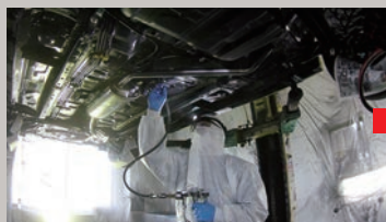
アンダーカバーを取り外して水性密封剤「ブラック」を塗布(約1～1.5ℓ)
