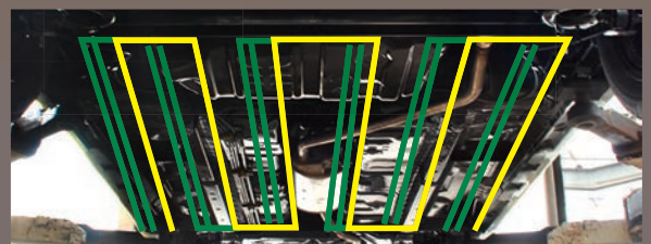
水性密封剤「ブラック」を塗布 無公害な油性浸透剤「ブラウン」で合わせ目や空洞部分を塗布
